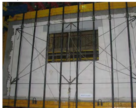
Rys. 30. Widok badanych modeli skrępowanych [37], [34], [35]: a) model skrępowany bez otworu HOS-C-AAC, b) model skrępowany z otworem HAS-C1-AAC, c) model skrępowany obwodowo i przy otworze HAS-C2-AAC
