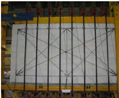
Rys. 29. Widok badanych modeli nieskrępowanych [37], [34], [35]: a) model nieskrępowany bez otworu HOS-AAC, b) model nieskrępowany z otworem HAS-AAC
